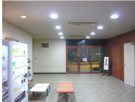
改修後 (ツイン3蛍光灯 FHT54W) 464lx 寿命は 10 倍 (10,000H)
