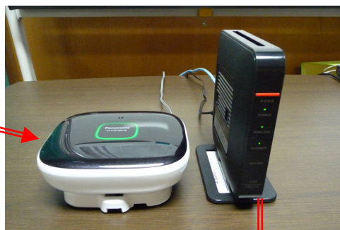
ホームユニット(無線) 無線ハブ (ルーター)
